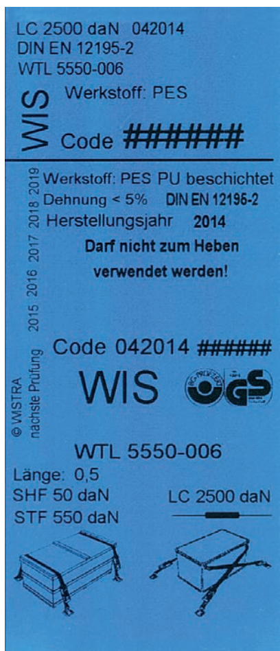
the WIS label (example WTL 5550-006 SE 0.5 m)
